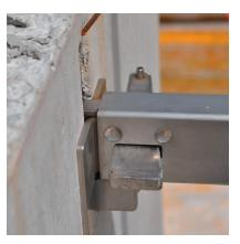
Ein Fixierungspunkt, eine Höheneinstellung perfekt für die Nivellierung der gesamte Decke. Der Laser kann bei Feierabend abgenommen werden und am nächsten Tag wieder aufgesetzt werden, um die Arbeit mit der selben Ausgangslage fortzusetzen. Eine riesen Zeitersparnis!
